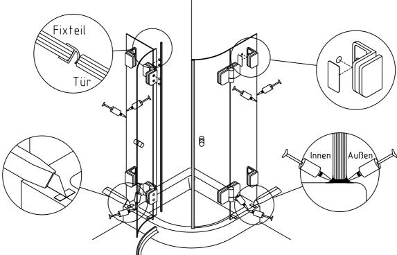
PVC-Streifen vorsichtig kürzen, Montagehilfen entfernen Dichtungen aufstecken Kappen aufkleben
